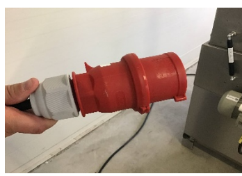
415 Volt 32 A 3-Phasen-Neutral- & Erdungsstromversorgung
