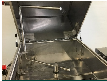
Düsenstock mit oberer, unterer und seitlicher Düse
